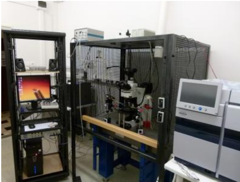
Gázkromatográfal kapcsolt egyedi érzékszőr idegi elvezetésére alkalmas műszer (Single Sensillum Recording – SSR)
